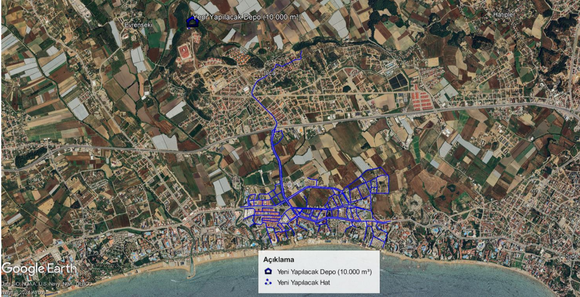
Şekil 7: Manavgat Ilıca Mahallesi İçme Suyu İsale ve Şebeke Hatları Rehabilitasyonu
